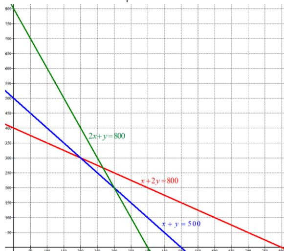
Como las restricciones son  $\left. \begin{array}{l} x + 2y \leq 800 \\ 2x + y \leq 800 \\ x + y \leq 500 \\ x \geq 0; y \geq 0 \end{array} \right\}$  es la región del primer cuadrante que está por debajo
